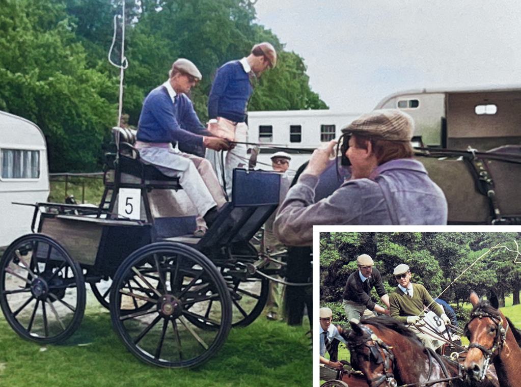
Der nach dem Plänen Prinz Philips 1979/80 realisierte Marathonwagen-Prototyp oder wie er es formulierte: „The daddy of them all“. Das Neue daran war vor allem der hinten offene, tiefe Einstieg für die Grooms. Das Bild wurde 1981 von Alex Sieber in Zug aufgenommen.
