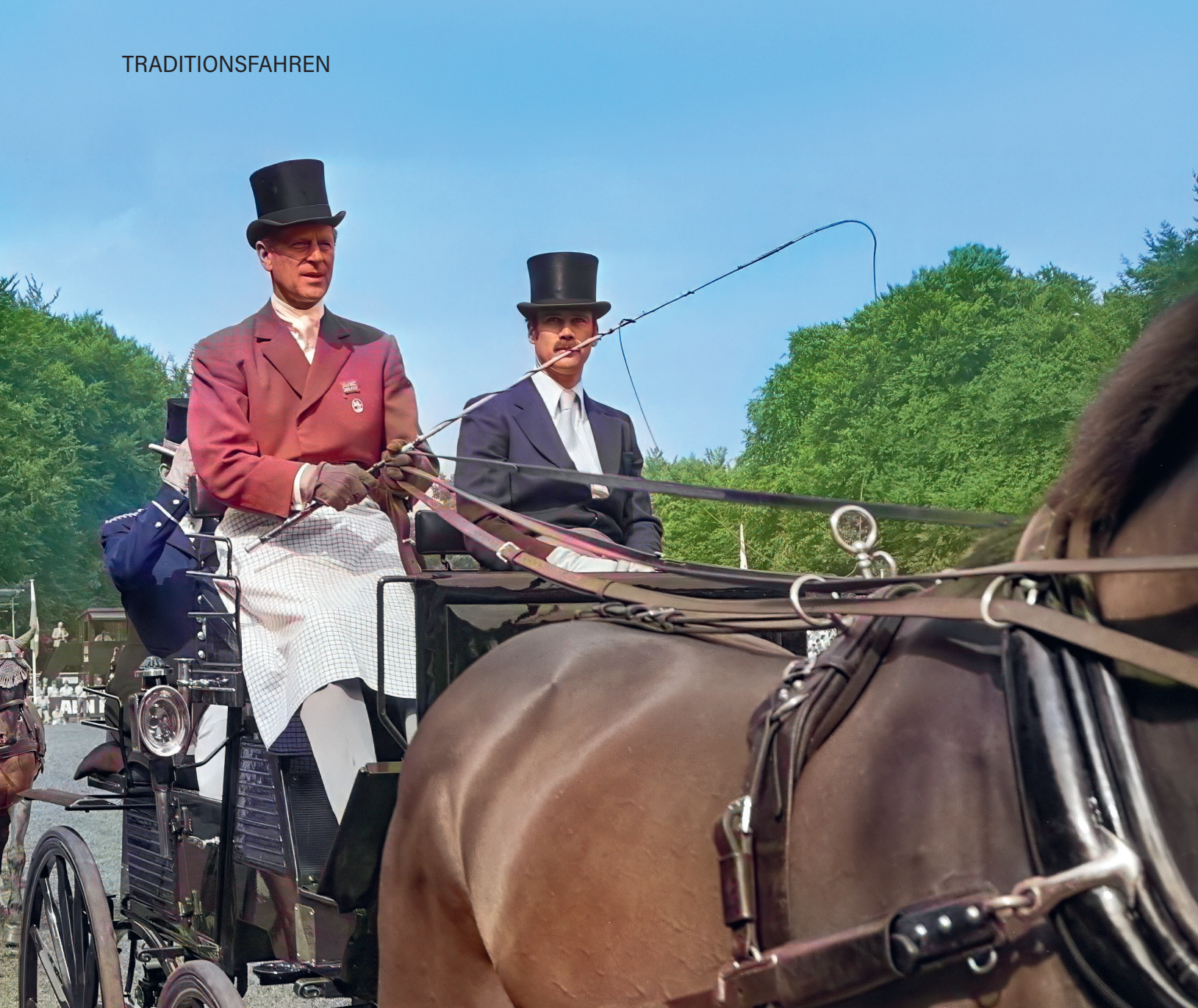
Prinz Philip 1982 in Apeldorn beim Schloss Het Lo. Er sitzt mit David E. Saunders, seinem Head Coachman, auf dem Bock des neuen Stahlwagens «Iron Maiden». Die vier Leinen sind mittels Löcher und «Manschettenknopf» genannter Schraubverbindung hinter der Hand miteinander fixiert (heller Quersteg unter der linken Hand). Foto: Wikimedia Commons (nachcoloriert)
