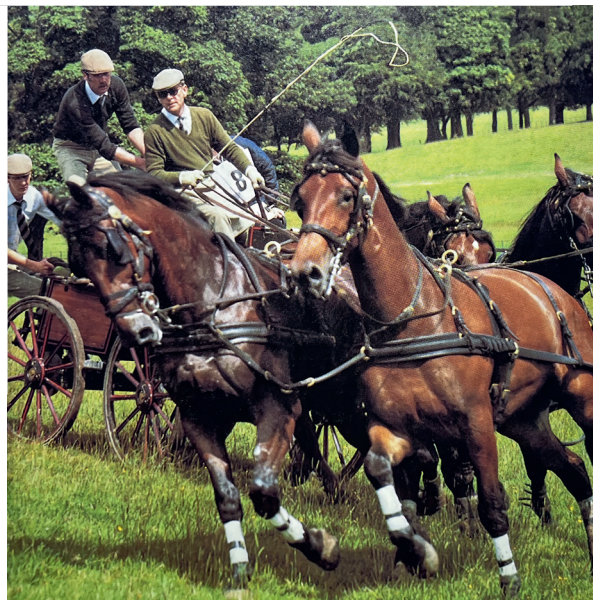
Der nach dem Plänen Prinz Philips 1979/80 realisierte Marathonwagen-Prototyp oder wie er es formulierte: „The daddy of them all“. Das Neue daran war vor allem der hinten offene, tiefe Einstieg für die Grooms. Das Bild wurde 1981 von Alex Sieber in Zug aufgenommen.
