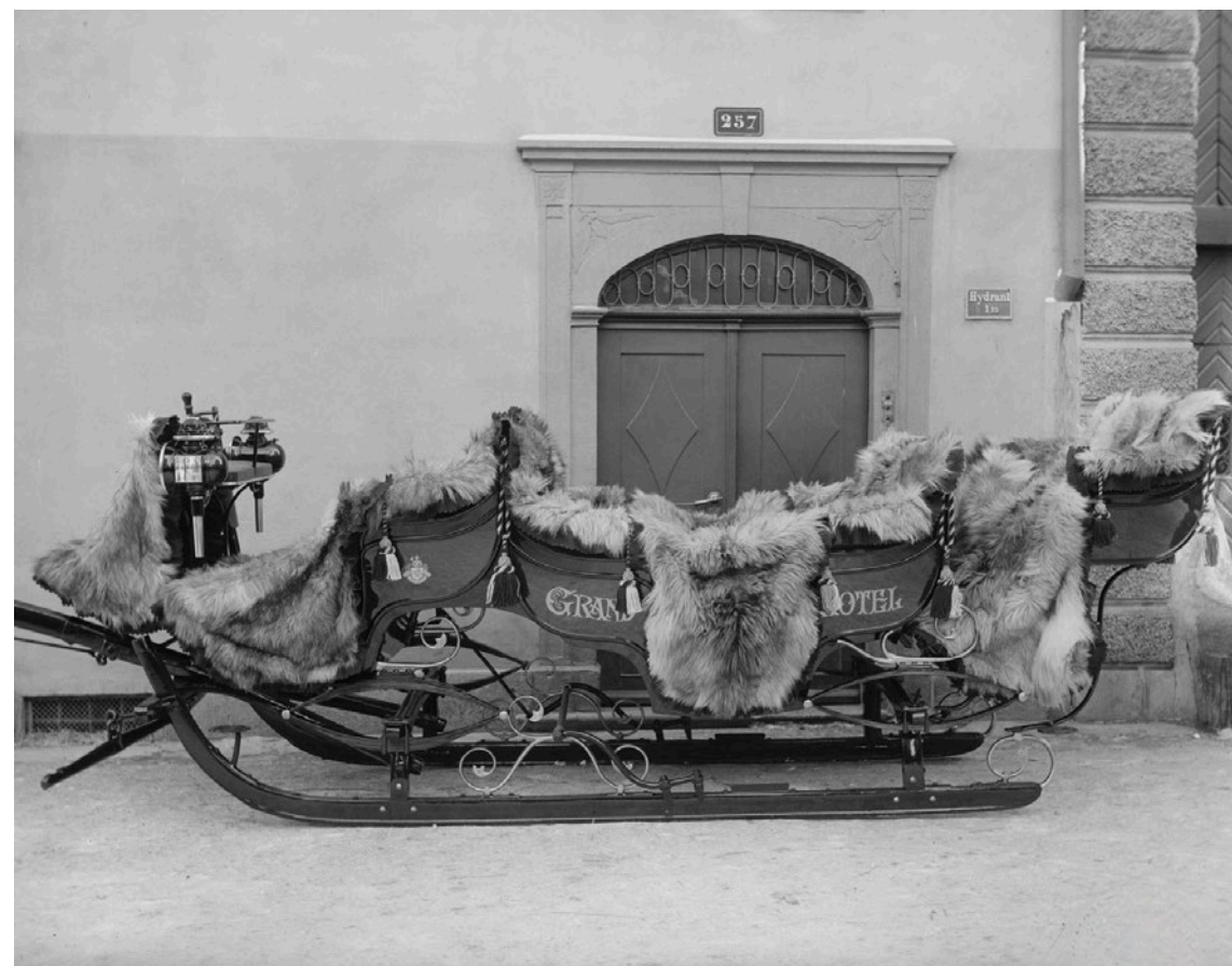
Achtplätziger Schlitten eines grossen Hotels in St. Moritz um 1910 Zur technischen Ausrüstung des Schlittens wohl des Grand Hôtels Des Bains in St. Moritz Bad gehörten eine Kratzerbremse, Laternen und Elliptikfederung sowie ein Unterzug zum mehrspännigen Fahren. (Staatsarchiv Graubünden, Fotobestand Lienhard & Salzborn)
