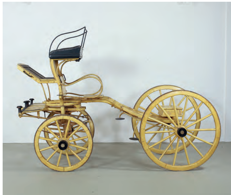
Skeleton-Break in der Sammlung Heinz Scheidel, Mannheim. Bei diesem Einfahrwagen ist die Konstruktion des Ganzen auf ein Minimum, gewissermaßen auf das Skelett reduziert. Foto: Archiv Furger
