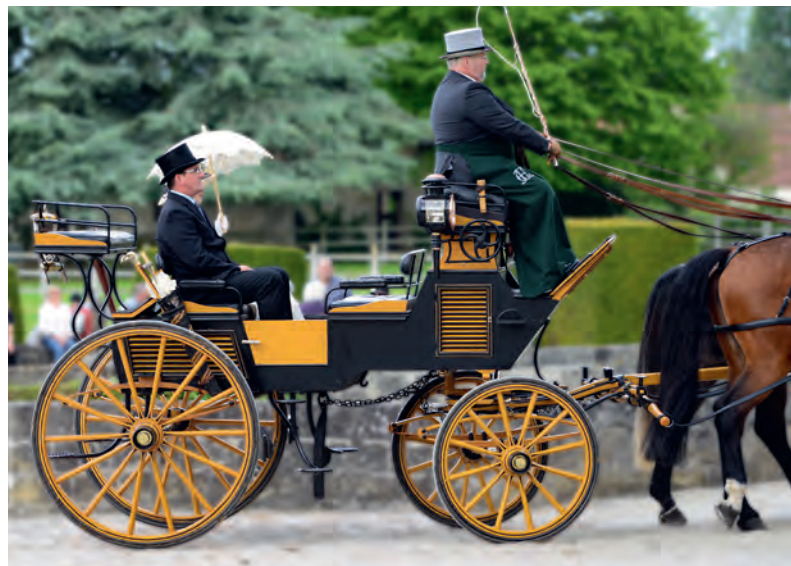
Diese Art Break beschrieb die „Deutsche Fahrzeug-Technik“ 1907 als „vornehmer Gesellschaftswagen“ und schrieb dazu: „Es ist dies ein für Picknicks, Landpartien sowie Jagdausflüge gleich gut verwendbarer Wagen. Regel bei diesem Gefährt ist der auch im Wesentlichen gleichbleibende gerade schwere Unterkasten, der vorne hohe Kutschersitz und der hinten entweder auf Stützen ruhende (der gebräuchlichste) oder massive Dienersitz. Die Mittelsitze findet man in Vis-à-vis-Anordnung.“ Foto: Thomas Sagkob
