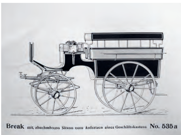
Eine Möglichkeit der multifunktionalen Nutzung: Diese norddeutsche Wagonette konnte unter der Woche mit einem aufgeschraubten Geschäftskasten eingesetzt und am Wochenende für die Familienausfahrt mit Bänken versehen werden. Abbildungen: Archiv Furger
