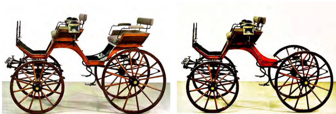
Abb. 13 Oppenheimer der Zeit um 1900 aus Norddeutschland in der Sammlung Scheidel in Mannheim. Links: Rückbank ausgeklappt. Rechts: Rückbank eingeklappt.
